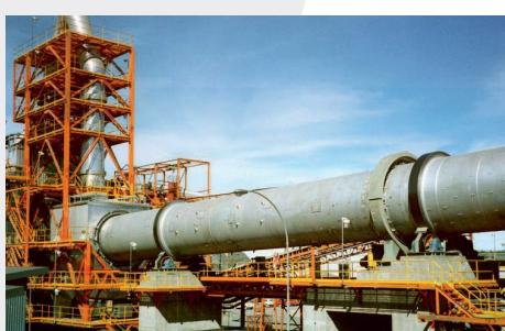
Традиционные вращающиеся сушилки по-прежнему актуальны для избранных случаев, например, для сушки концентратов на металлургических заводах, где нет достаточно пара, или обработки твёрдых веществ боковых потоков в небольшом количестве.
