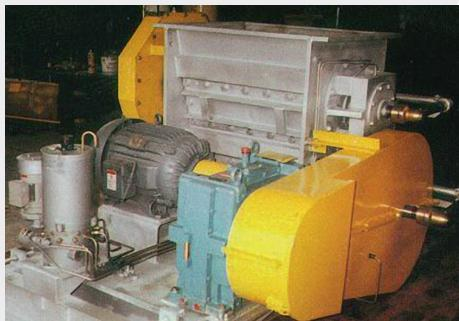
Валковые дробилки Кумера предназначены для разрушения затвердевшей пыли, скопившейся после электростатических фильтров и котлов-утилизаторов тепла отходящих газов. Дробилки сконструированы для тяжёлых условий работы и принимают горячие, липкие и абразивные материалы. Надёжность обеспечена водяным охлаждением роторов, наружными опорами и подбором специальных конструкционных материалов.
