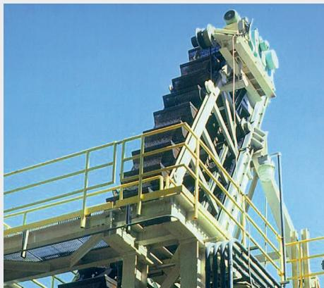
Ковшовые экскаваторы Кумера предназначены для подъёма гранулированных штейна и шлака. При подъёме содержание влаги в материале снижается до примерно 10%. Экскаватор оснащается автоматической системой управления производительностью и эксплуатацией.
