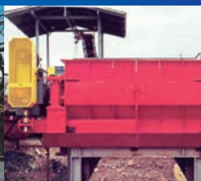
库迈拉驱动有限公司还提供转鼓驱动的成套功能组件,包括齿轮装置、小齿轮、大齿圈和装配底座。
