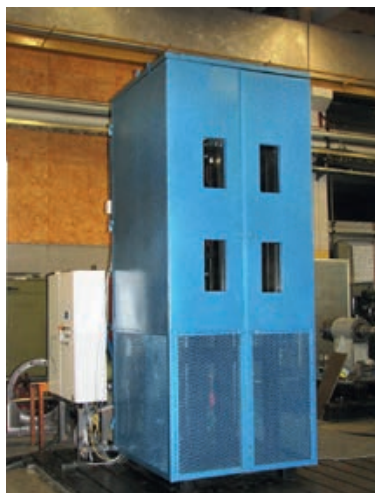
这个检测室可以在最高环境温度150°C条件下进行阳极升降装置的载荷检测。
