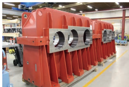
Gehäuse von Getrieben für die Zementindustrie.
