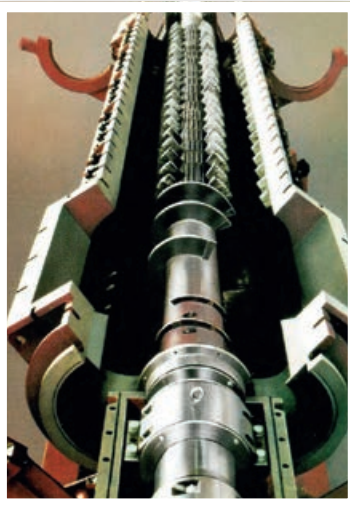
Kompletter Durchlaufmischer / Knetmaschine mit Oszillationsgetriebe.
