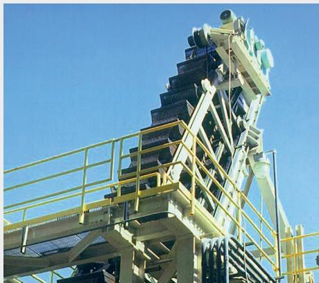
Las Excavadoras de Capacho Kumera para levantar mate granulado y escoria desde la fosa. Durante el transporte, el contenido de agua en el material se reduce a aproximadamente 10%. La Excavadora de Capacho Kumera está equipada con un sistema de control automático para controlar la operación y la capacidad de excavación.
