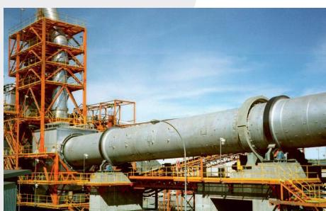
Las Secadoras de Tambor Giratorios Convencionales siguen siendo hoy en día adecuadas para aplicaciones especiales, como el secado de concentrados en fundiciones que no dispongan de vapor, y para sólidos de corriente lateral de baja capacidad.
