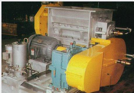
El Chancador de Rodillos Kumera está específicamente diseñado para romper el polvo aglomerado desde el precipitador electroestático y la caldera recuperadora de calor residual. El chancador está diseñado para trabajo pesado y por lo tanto, es adecuado para triturar metales calientes, pegajosos y abrasivos. Esto se obtiene utilizando rotores enfriados por agua, soportes de rodamientos externos y materiales de construcción apropiados.
