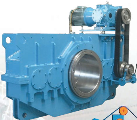
Accionamientos para cilindros yankee Par nominal de salida máx. 350 000 Nm Relación de transmisión 2,5 – 70 Diámetro de eje hueco 200 – 600 mm
