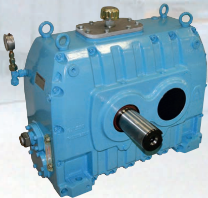
Серия LH Номинальный крутящий момент на выходе макс. 195 кНм Передаточное число 1 - 6,3
