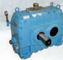
LX-Serie Abtriebsdrehmoment max. 195 kNm Übersetzungsverhältnis 1 - 6,3
